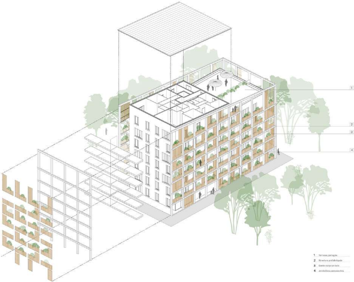
↑ axonométrie éclatée sur système constructif compacité de l'enveloppe habitable et préfabrication des éléments de loggias
